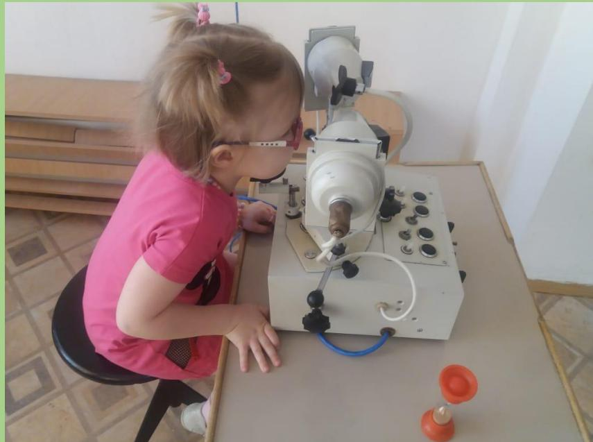
**Большой безрефлексный офтальмоскоп** – предназначен для исследования глазного дна при большом увеличении и отсутствии посторонних световых рефлексов от роговицы и хрусталика исследуемого глаза, а так же для калиброметрии сосудов сетчатки, рефрактометрии, для диагностики и лечения эксцентричной фиксации.
